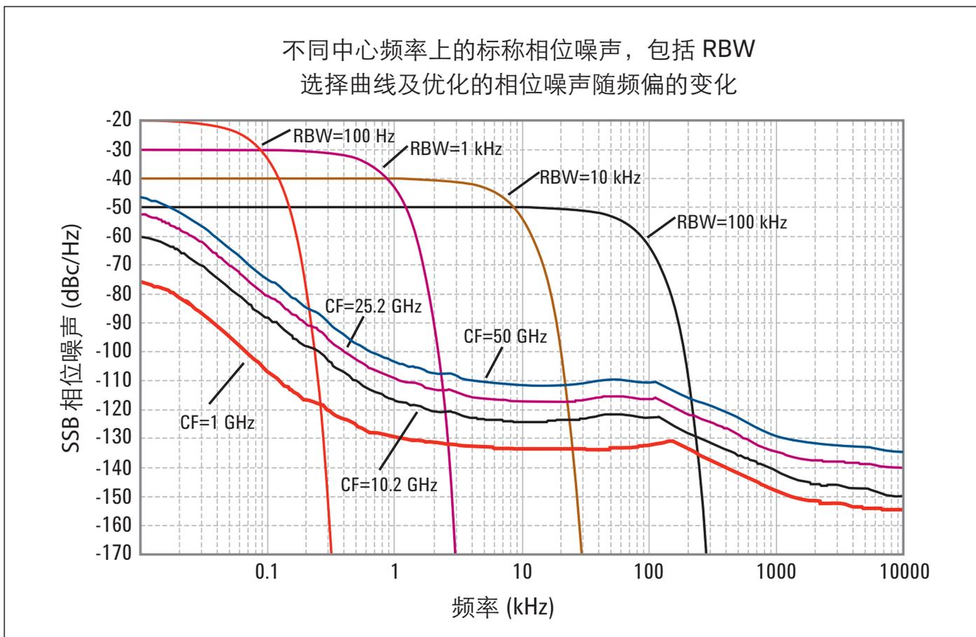
图 3. 不同中心频率上的额定 PXA 相位噪声
